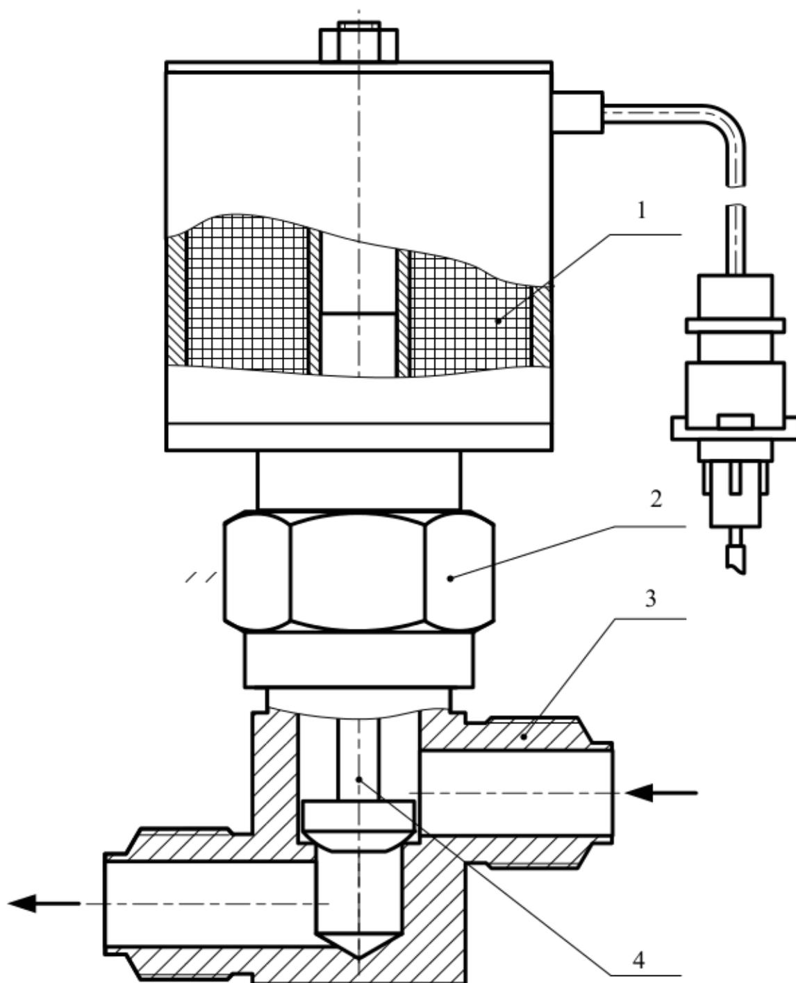
1 - Электромагнит; 2 - Гайка накидная; 3 - Корпус; 4 - Клапан
